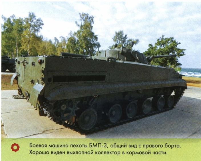
Боевая машина пехоты БМП-3, общий вид с правого борта. Хорошо виден выхлопной коллектор в кормовой части.
