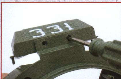
**6** Используйте отвертку, закрутите винт. Но не затягивайте слишком сильно, чтобы не повредить стенки отверстия.
