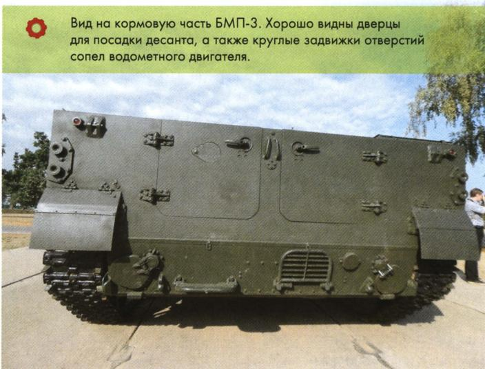
Вид на кормовую часть БМП-3. Хорошо видны дверцы для посадки десанта, а также круглые задвижки отверстий сопел водометного двигателя.
